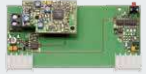
Receptor HER 1 (1 canal) Con salida de relé libre de potencial, sin cable de conexión o como pletina encastrable en el cuadro de maniobra
