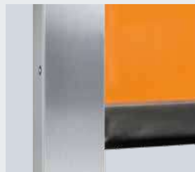
V 10008 El enhebramiento especialmente ancho de la persiana en el carril-guía permite elevadas cargas de viento.
