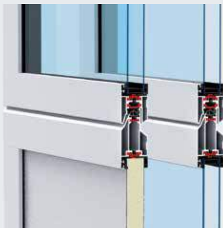
Panel inferior con relleno de espuma PU (izq.) o a elección con acristalamiento (der.)
