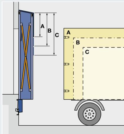
Adapte el alto de la lona superior al alto del vehículo. Óptimo: 150 mm de solapamiento
