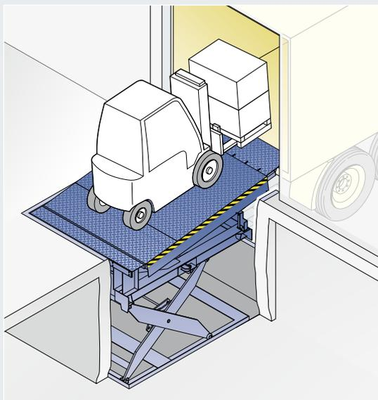
Liftableveller rampa niveladora de uña retráctil combinada con mesa de tijera
